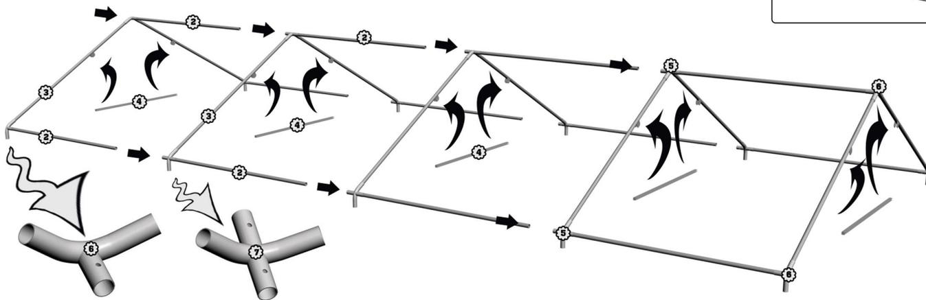
**2А приподняв крышу с одной стороны, установите в верхний тройник стойку (сначала вторую и четвертую, затем остальные)**
